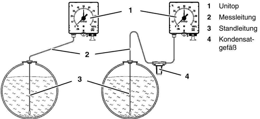
*Bild 2: Unitop ohne (links) und mit Kondensatgefäß (rechts)*
