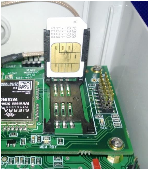
Bild 9: Installation der SIM-Karte im EMS 442
